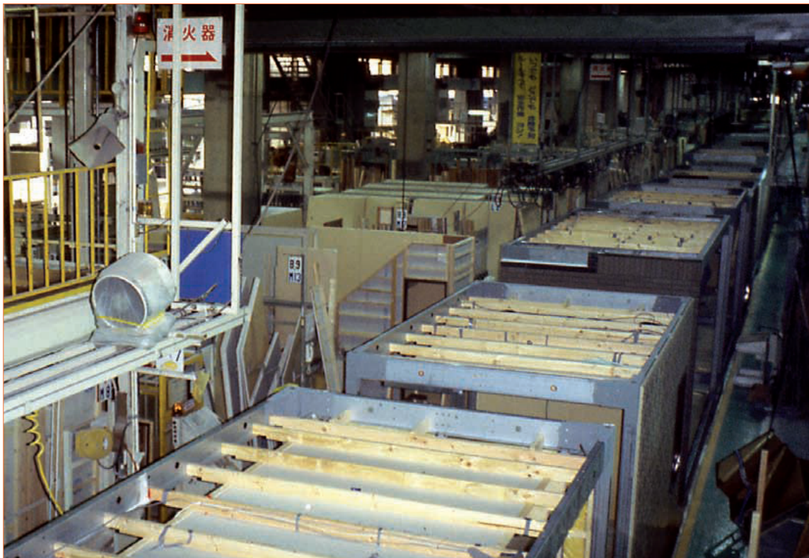
Bild 01: rationalisierte Fertigung individueller Gebäudemodule und Gebäude-sub-module im Fließbandverfahren, Sekisui Heim, Japan
