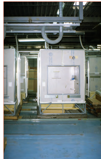
Bild 3: Fließfertigung von Badraumzellen (Subsystemen) auf Unterboden als Trägerstruktur, Firma: Inax, Nagoya.
